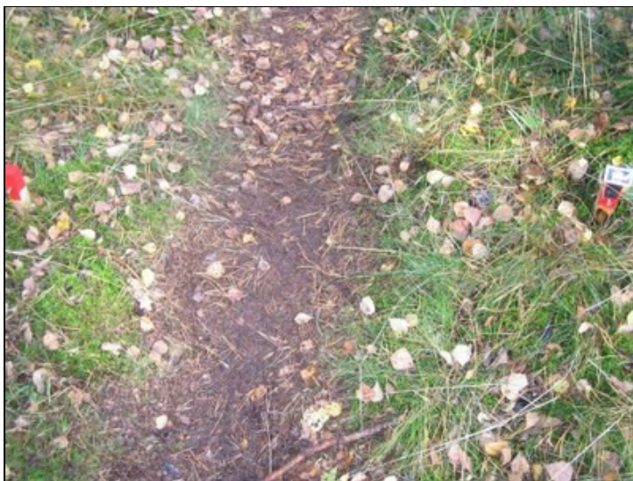
Figur 3: Sandjord, Tisvilde hegn, Mountainbike. Efter 14 runder (dvs. efter 28 uger) á 56 passager = 784 passager i alt.
